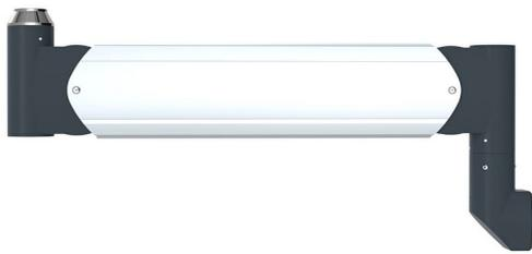
Stufenlos höhenverstellbarer Tragarm, Systemlänge 500 mm, mit Fusslageranschluss HMA I-080 unten und Kopflageranschluss HMA I-040 oben
