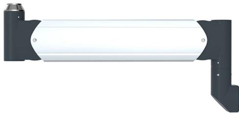
Stufenlos höhenverstellbarer Tragarm, Systemlänge 800 mm, mit Fusslageranschluss HMA I-080 unten und Kopflageranschluss HMA I-040 oben
